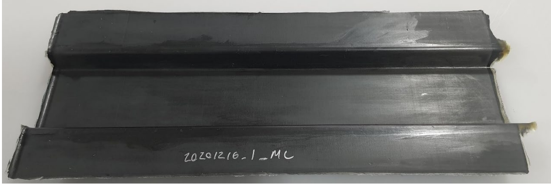
Figure 11 260°F Preheat Hat Stiffener
